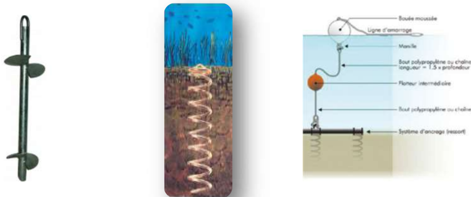
Figure 7 : Ancre à vis pour les herbiers (droite) et à spirale pour le sable (centre) et double ancre (gauche)
